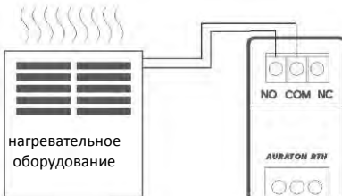
Упрощенная схема подключения AURATON RTH к нагревательному оборудованию
